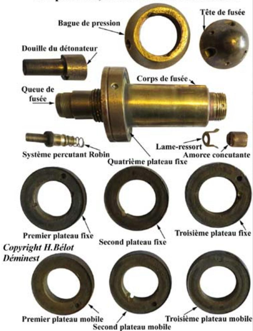
**Fusée détonateur à double effet de 24/51 mm
