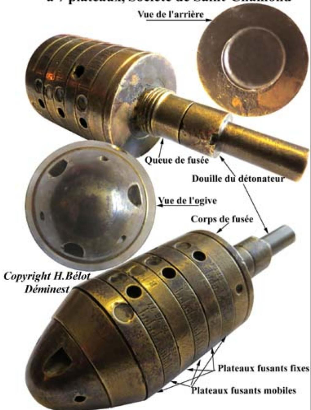
**Fusée détonateur à double effet de 24/51 mm
